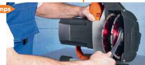
Plus besoin de retirer les disques diamantés pour modifier le réglage de la largeur de coupe.
